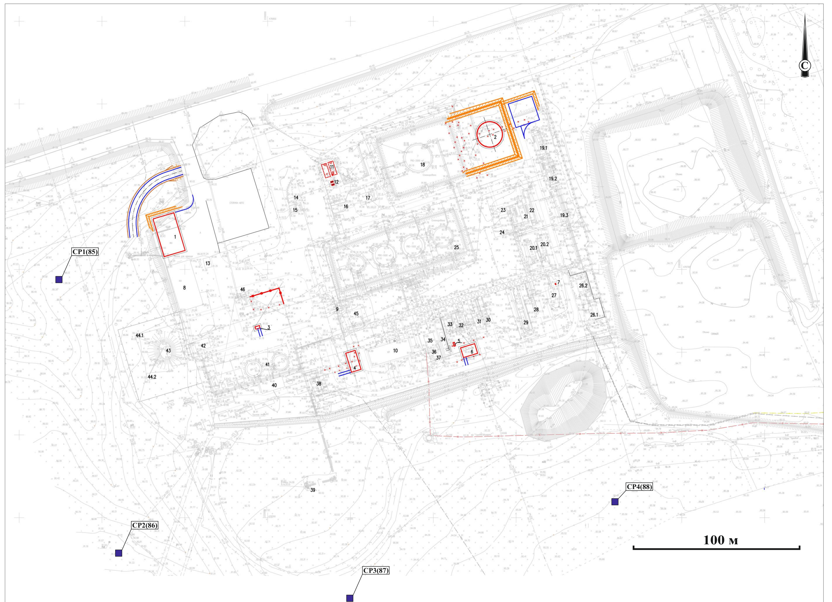
Рис. 4 а. Топографический план проектируемых работ по объекту «Реконструкция УПН «Луговое» ТПП «ТатРИТЭКнефть» и расположение рекогносцировочных стратиграфических разрезов
